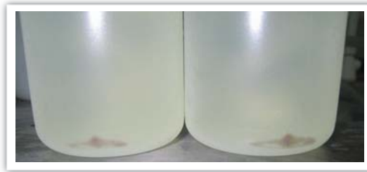
그림 6. 세척용액을 원심 분리한 침전물 수거 과정
