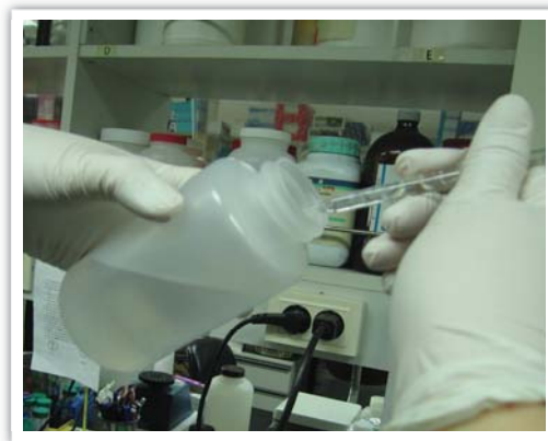
그림 7. 진공흡입장치를 사용하여 상층액을 제거하는 과정
