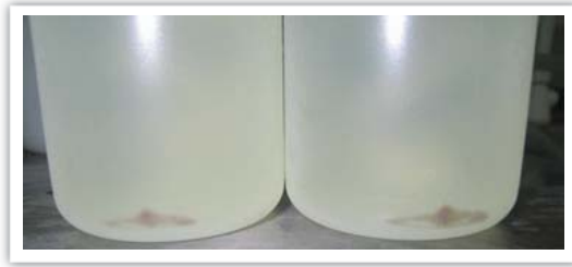
그림 6. 세척용액을 원심 분리한 침전물 수거 과정
