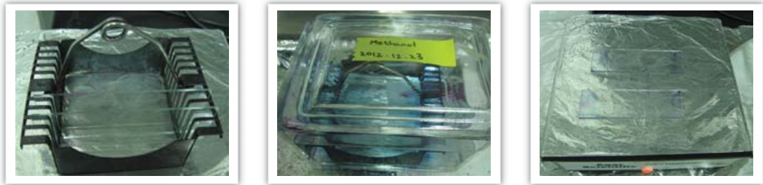
그림 22. 건조된 슬라이드를 methanol에 담가 heating plate에서 건조 과정
