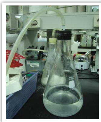
그림 7. 진공흡입장치를 사용하여 상층액을 제거하는 과정
