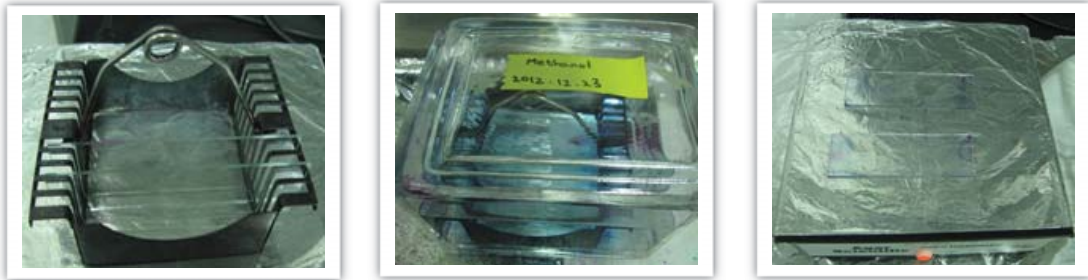
그림 16. 건조된 슬라이드를 methanol에 담가 heating plate에서 건조 과정
