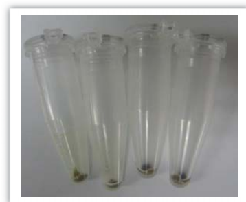
그림 9. 진공흡입장치로 상층액 제거 후 원심 분리하여 생긴 침전물
