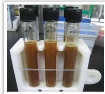
그림 16. Magnetic concentrator(MPC-S, MPC TM -6와 L-10 tube)
