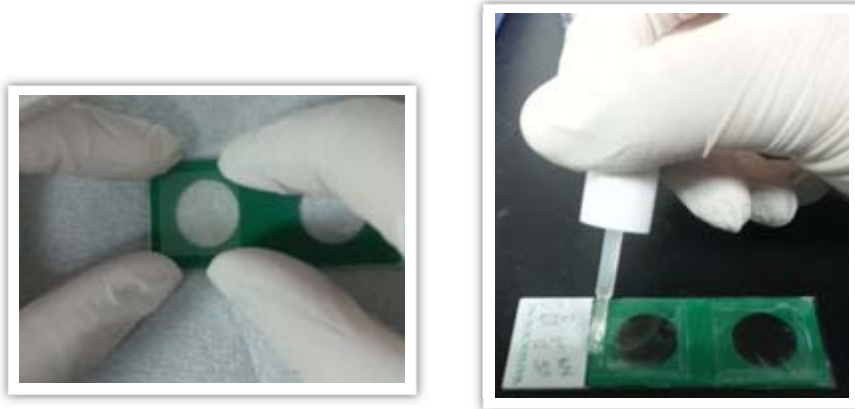
그림 17. 커버글라스를 덮고 매니큐어를 칠하는 과정
