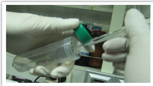
그림 9. 진공흡입장치로 상층액 제거 후 원심 분리하여 생긴 침전물
