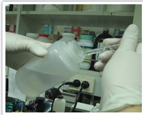
그림 7. 진공흡입장치를 사용하여 상층액을 제거하는 과정
