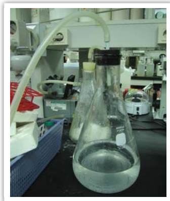
그림 7. 진공흡입장치를 사용하여 상층액을 제거하는 과정
