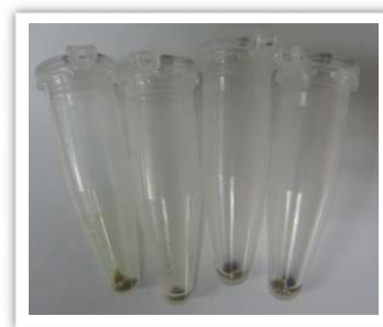
그림 9. 진공흡입장치로 상층액 제거 후 원심 분리하여 생긴 침전물
