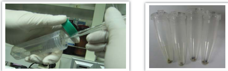
그림 9. 진공흡입장치로 상층액 제거 후 원심 분리하여 생긴 침전물
