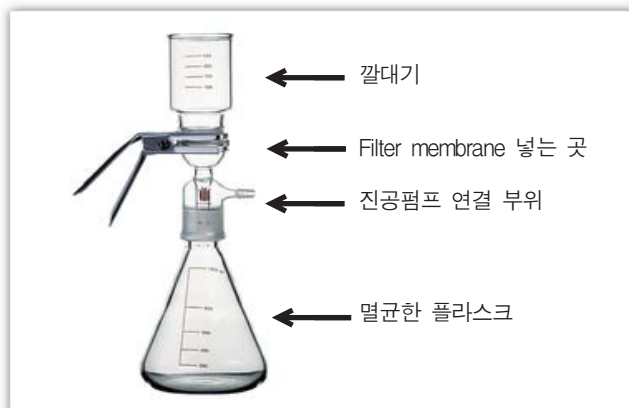
그림 1. Millipore 여과 장치 및 filter membrane(0.22 \mu m filter)
