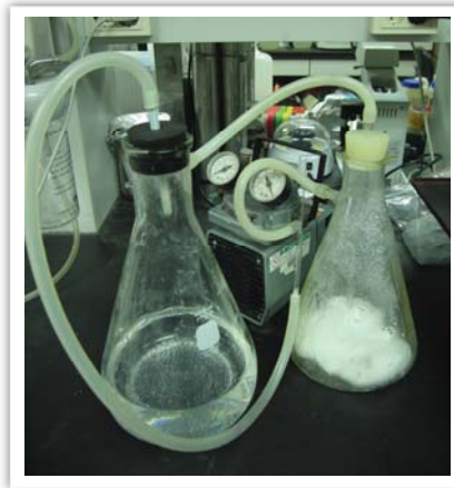
그림 3. 진공흡입장치 (Vacuum suction)
