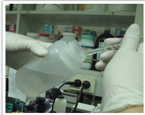
그림 7. 진공흡입장치를 사용하여 상층액을 제거하는 과정
