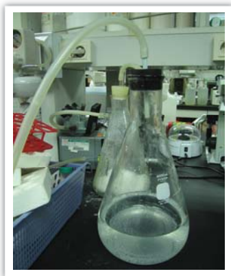
그림 7. 진공흡입장치를 사용하여 상층액을 제거하는 과정
