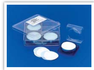
그림 1. Millipore 여과 장치 및 filter membrane(0.22 \mu\text{m} filter)
