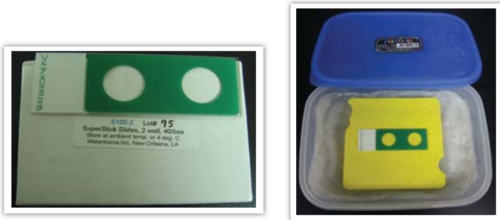
그림 29. 형광염색용 슬라이드글라스와 humid chamber
