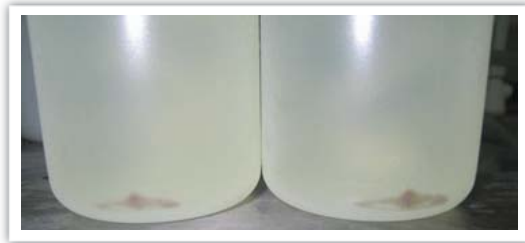
그림 6. 세척용액을 원심 분리한 침전물 수거 과정
