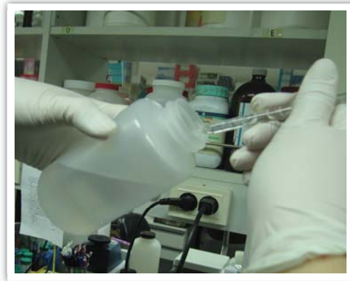
그림 7. 진공흡입장치를 사용하여 상층액을 제거하는 과정
