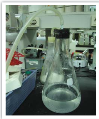
그림 7. 진공흡입장치를 사용하여 상층액을 제거하는 과정
