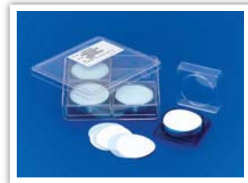
그림 1. Millipore 여과 장치 및 filter membrane(0.22 \mu m filter)
