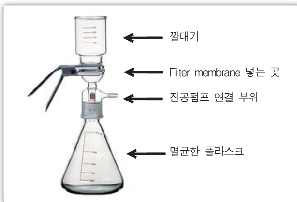
그림 1. Millipore 여과 장치 및 filter membrane(0.22 \mu m filter)
