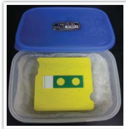
그림 16. 형광염색용 슬라이드글라스와 humid chamber
