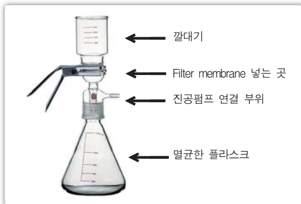
그림 1. Millipore 여과 장치 및 filter membrane(0.22 \mu\text{m} filter)
